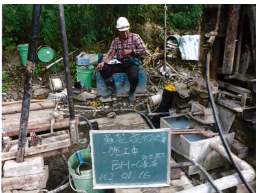
圖五 蘇花改滲漏試驗
