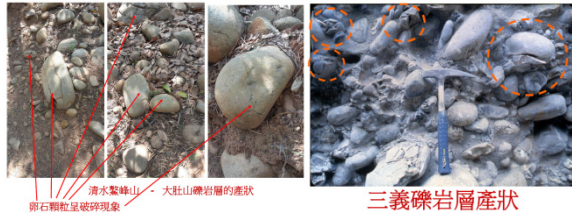
圖二 斷層直接切過地層造成卵石顆粒破碎
