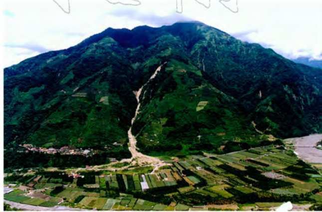
圖一 鳥瞰一條完整的土石流，民國 85 年賀伯颱風豪雨事件之豐丘土石流；上豐丘原住民社區安然無恙，下豐丘社區(土石流堆積扇)災情慘重 (林銘郎教授攝於民國 85 年)
