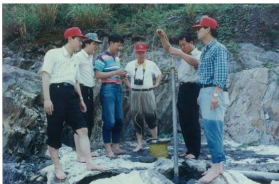
照片十三 中橫高速公路計劃可行性研究現場地溫測定
