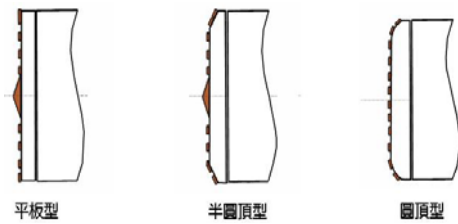
圖五 切刀轉盤前端的型狀種類
