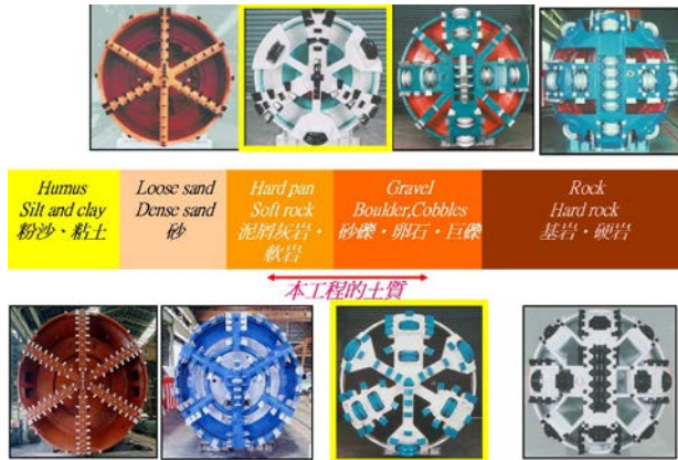
圖四 切刀轉盤型式及其適用土層範圍示意圖
