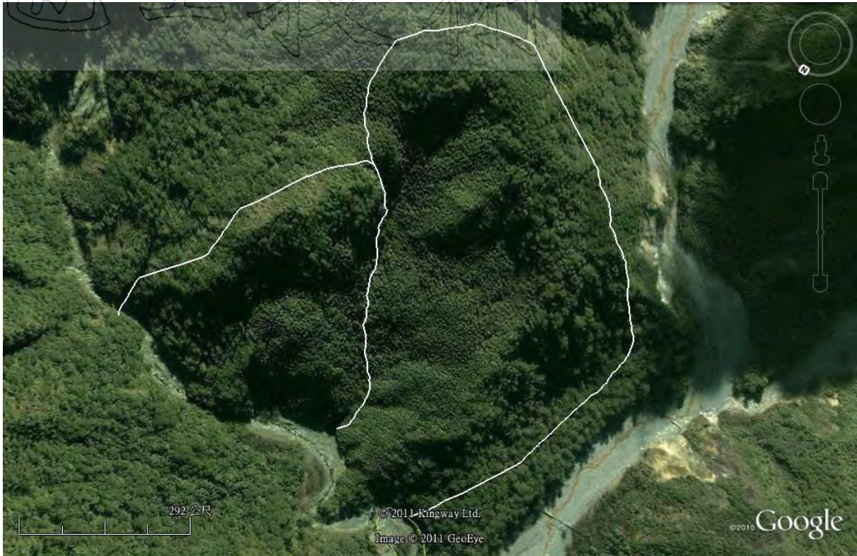
影像四 逆向坡滑動及堰塞湖
