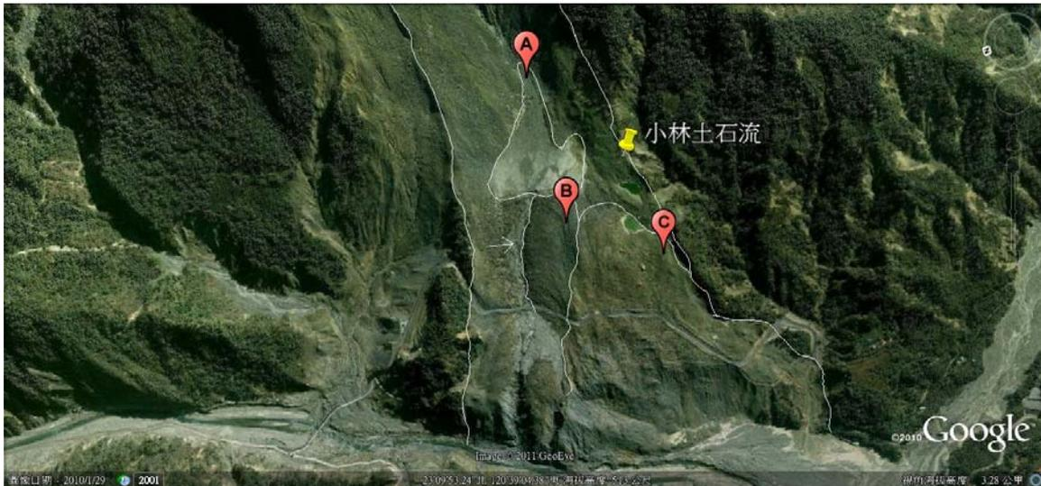
圖四 順向坡滑動造成的土壤 B，堵塞了曲河的河谷；A 為災後清水時期所形成的小堰塞湖（影像來源：Google Earth）
