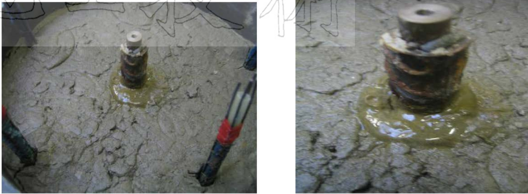
圖九 未經 EKG 處理脫水礦渣中土釘於拉出時其周圍土壤發生液化現象(Jones 等人，2008)
