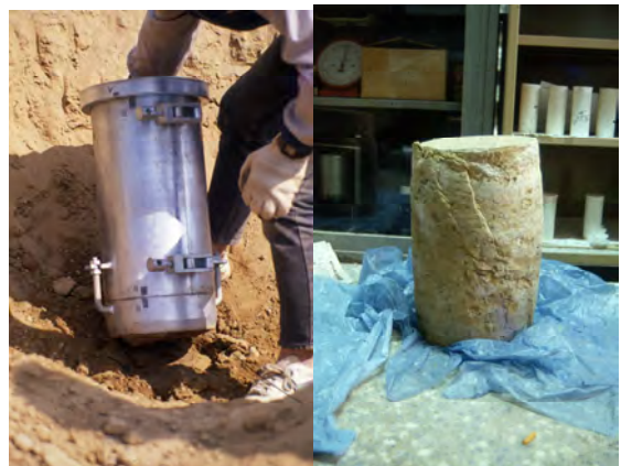
圖五 鯉魚潭現地取樣與三軸試驗結果(78/2)
