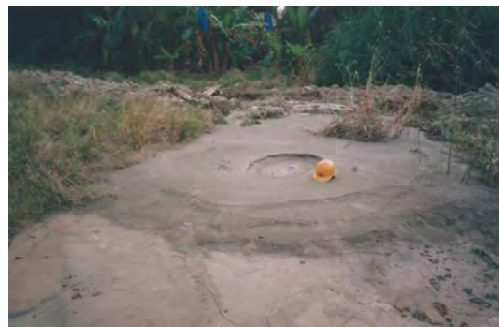
投影片八 集集(921)地震液化破壞(二)
