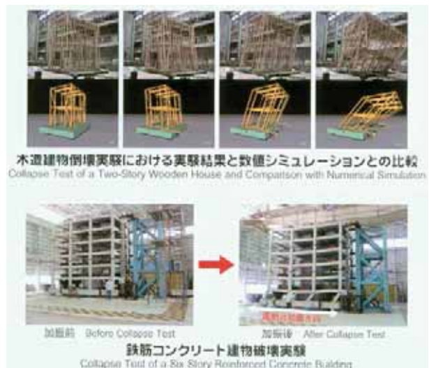
圖 11.4 上：木造結構振動破壞試驗；下：鋼筋混凝土結構振動破壞試驗
