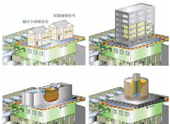
左上：現有木造建物與補強木造建物之耐震性能比較試驗 右上：全尺寸鋼筋混凝土建物受震破壞試驗； 左下：地盤受震產生側向流動試驗； 右下：土壤－基礎互制行為試驗
