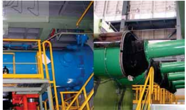
圖 11.3 左：低壓油壓槽；右：起振器
