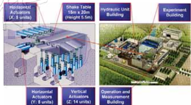
圖 11.1 右：三向度全尺寸震動破壞試驗設施 E-Defense；左：三向度振動台
